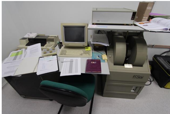
Figure 53 : Photo du spectromètre et du plan de travail pour la lecture des spectres de RPE.
