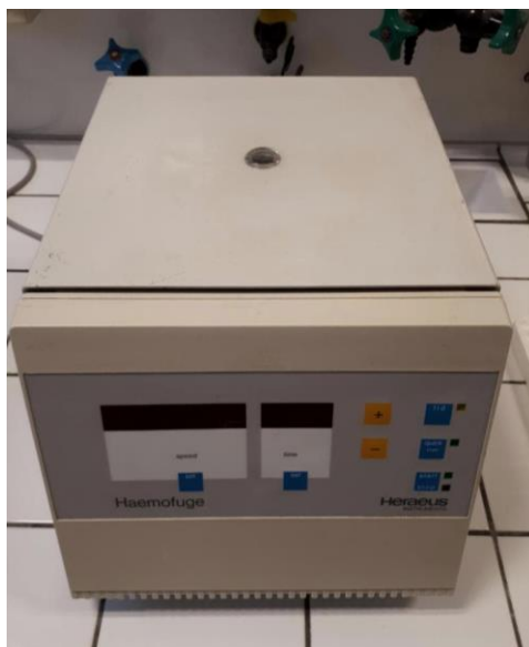
Figure 46 : Centrifugeuse à micro-hématocrite Haemofuge Heraeus®.
